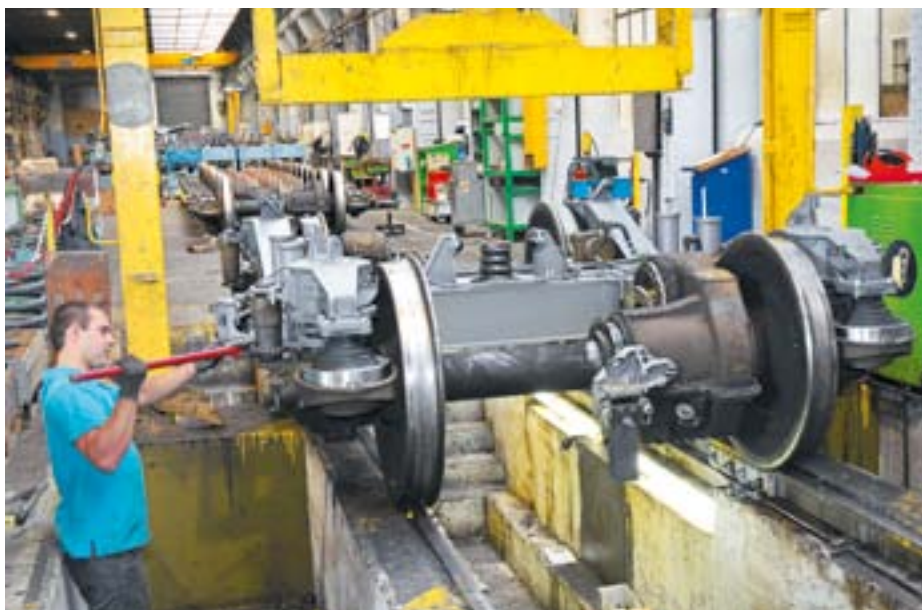
REMONTAGE DES BOGIES. Dans les vastes ateliers, les opérateurs SNCF se relaient par équipes, de 5 h du matin à 20 h.
